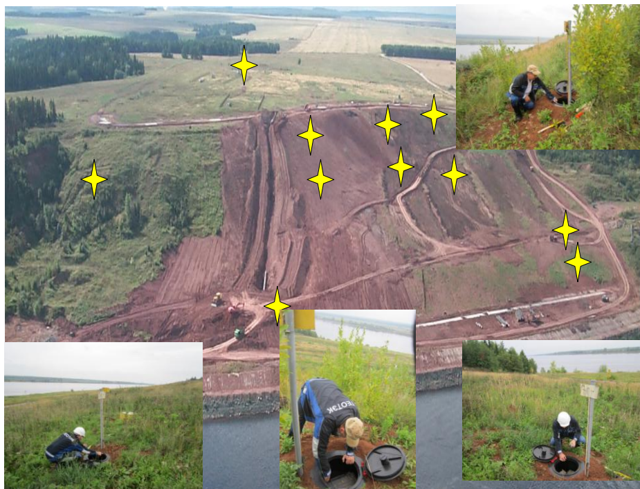
Рис. 62. Схема размещения станций на оползневом склоне
