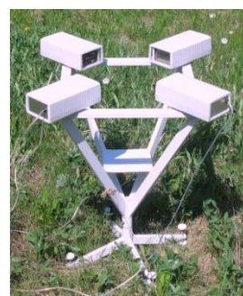
Рис. 45. Внешний вид оптико-электронного двухканального измерителя осадков
