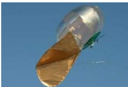
Рис. 53. Гибридные малогабаритные привязные аэростаты «Колибри» (МАИ, г.Москва)
