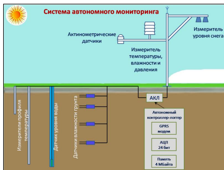
Рис. 3. Автоматическая метеорологическая станция с 3-м мачтой.
